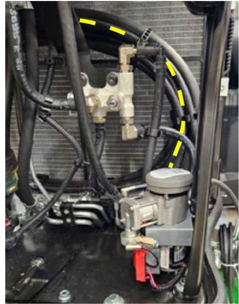
**HINWEIS****Sachschäden durch Anliegen des Wellrohrs an heiße Leitungen!**
