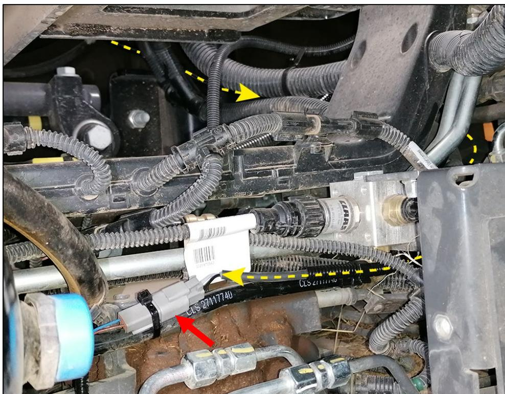
**AVVISO****Danni materiali a causa del contatto del tubo corrugato con tubi caldi!**
