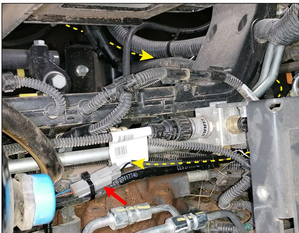
**REMARQUE****Domages matériels dus au contact du tube ondulé avec des conduites chaudes !**
