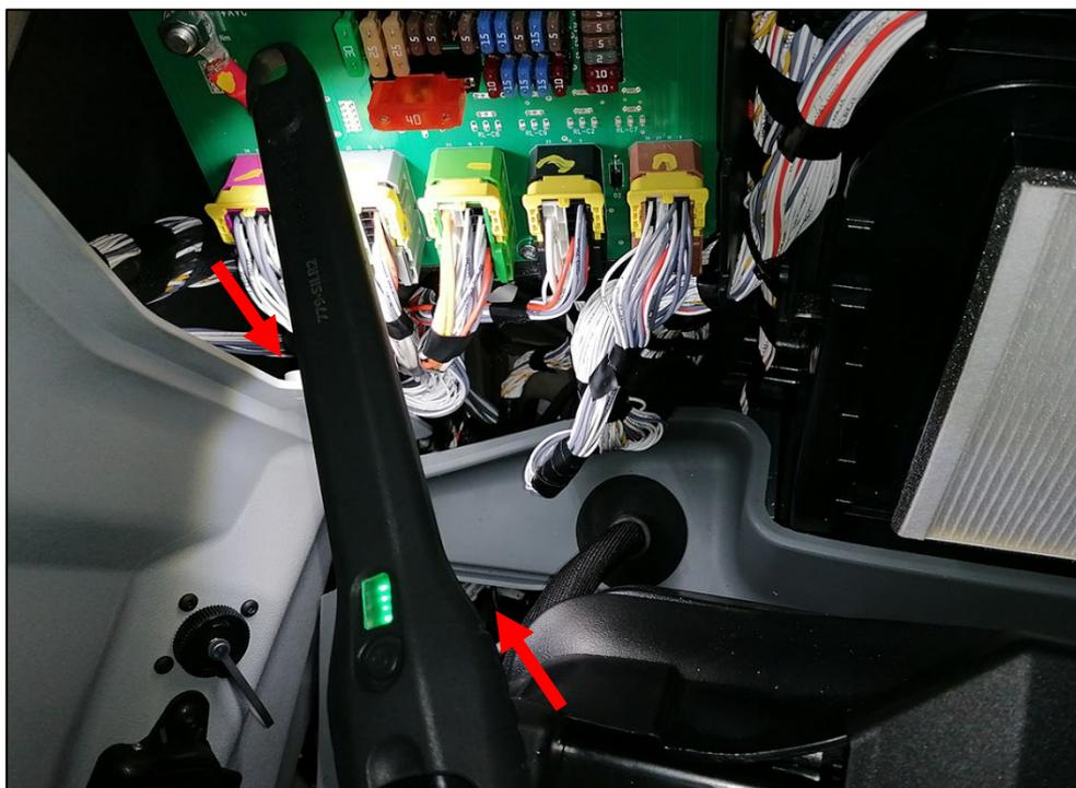
Enchufe para el sujetacables: vista desde el interior de la cabina en la parte trasera a la derecha
