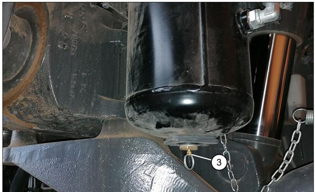
**Para una válvula de rebose en el lado del vehículo**
