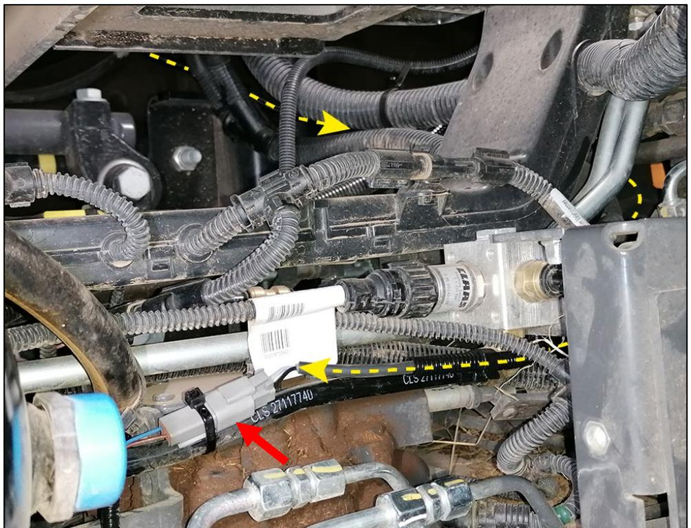
**HINWEIS****Sachschäden durch Anliegen des Wellrohrs an heiße Leitungen!**
