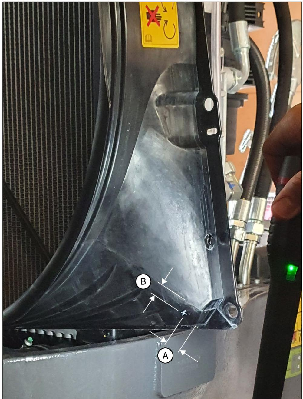
**HINWEIS****Sachschäden durch Bohren der Schlauchdurchführung!**
