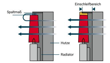
Mit Hilfe unserer Flex-Tips ist es jedoch möglich diesen Abstand auf ein Minimum zu reduzieren. Die flexiblen Flügelverlängerungen aus Hochleistungs-Kunststoff passen sich automatisch an jede Hutze an. Das führt zu Kraftstoffeinsparung, Leistungssteigerung und Lärmreduktion.
